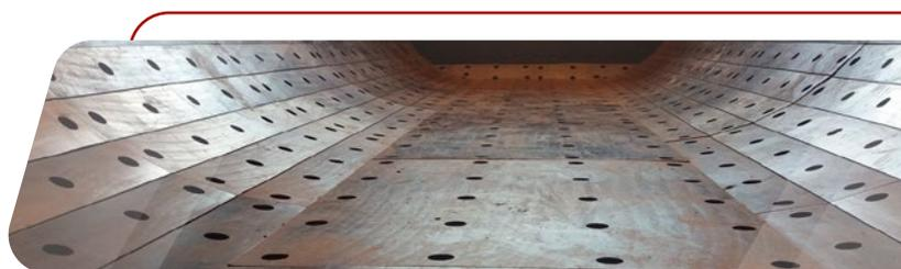
A linha **Duramaxx Ultra** foi desenvolvida para oferecer um excelente desempenho nas aplicações onde se necessita alta resistência à abrasão e antiaderência melhorada, pois possui estrutura molecular reticulada com aditivos funcionais, cargas cerâmicas e Silicone. Possui vida útil 30% maior quando comparado ao UHMW Tipo A, além de ser adequado para trabalhos em temperaturas mais elevadas, até 130°C, com picos de 150°C (classificação HOT).
